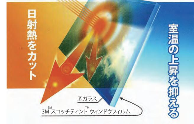
窓ガラスから室内に侵入する赤外線を遮って室温の上昇を抑制。熱線を90%以上カットし、最大で室温を5℃下げる効果があります。
